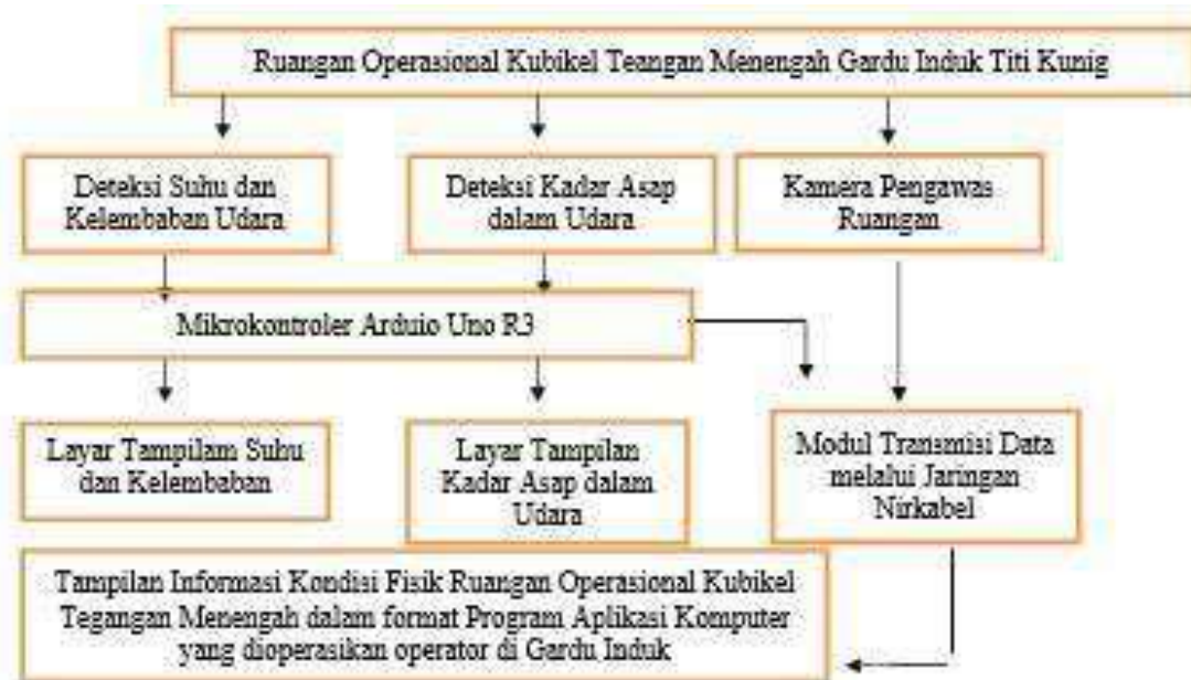
Gambar 7. Blok Diagram Rancangan Sistem Peringatan Perawatan dan Pengawasan Kubikel Tegangan Menengah secara Real-Time.
