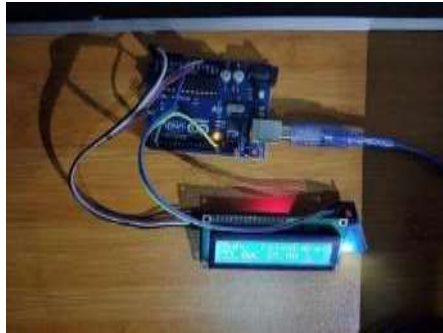
Gambar 9. Alat deteksi suhu dan kelembaban ruangan.
