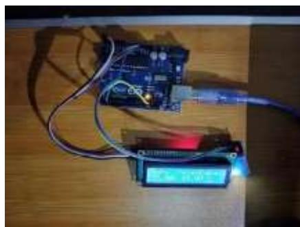
Gambar 8. Alat deteksi suhu dan kelembaban ruangan.
