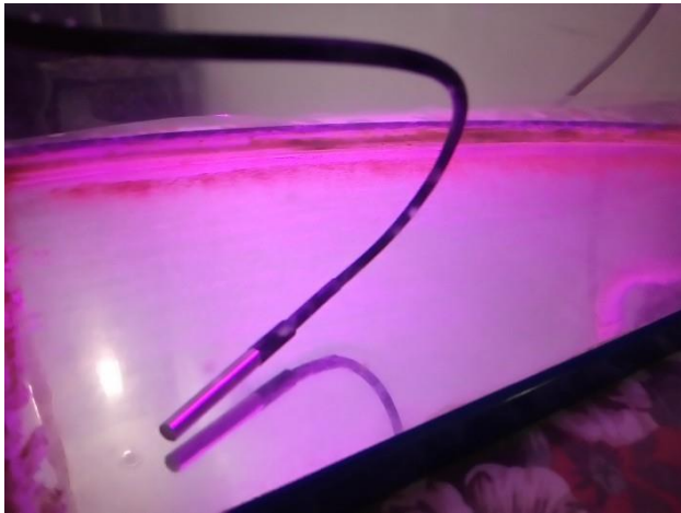
Gambar 4. Peletakan Sensor DS18B20
