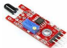
Gambar 5. Sensor Api KY-026 (Sumber : www.arduino.cc )
