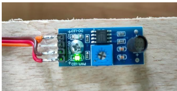
Gambar 21. Hasil Rangkaian Sensor LDR
