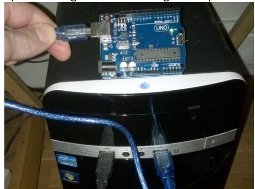
Gambar 9. Menghubungkan Arduiona dengan Komputer
