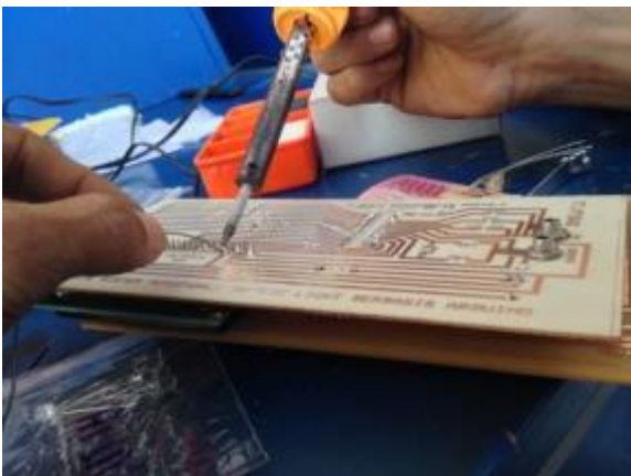
Gambar 13. Proses pemasangan dan penyolderan komponen Prototype sistem pengontrol traffic light berbasis Mikrokontroler AT328P dengan Arduino.
