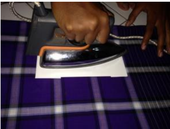
Gambar 8. Proses penyetricaan hasil Print out ke papan PCB
