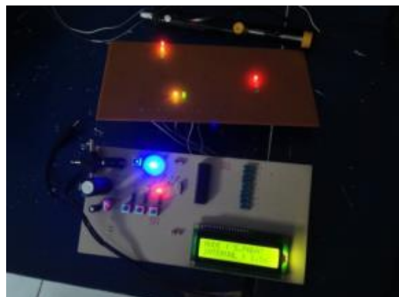
Gambar 15. Uji coba rangkaian saat rangkaian dinyalakan dan menjalankan Mode Sangat padat
