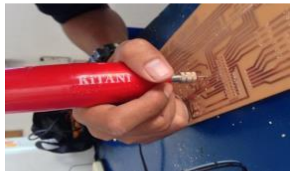
Gambar 11. Proses pengeboran papan PCB
