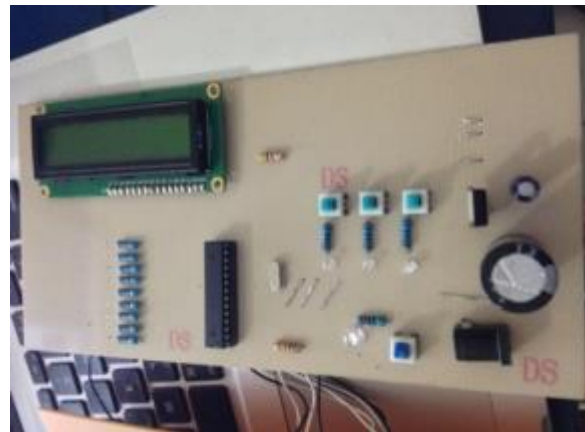
Gambar 14. Rangkaian Prototype sistem pengontrol traffic light berbasis Mikrokontroler AT328P dengan Arduino yang telah dirangkai dan dilakukan pemasangan komponen.
