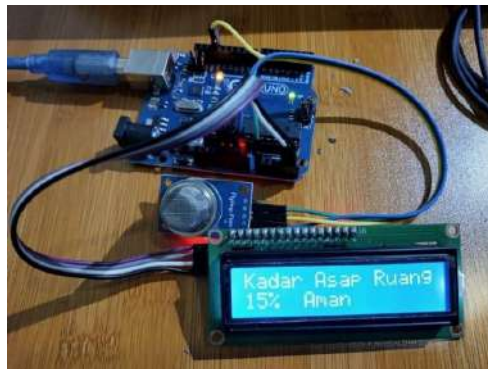
Gambar 10. Alat deteksi kadar asap dalam ruangan.
