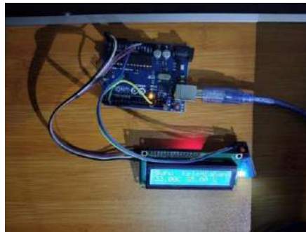
Gambar 8. Alat deteksi suhu dan kelembaban ruang.
