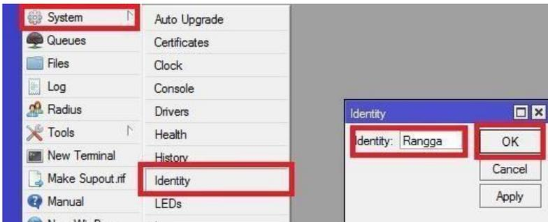
Gambar 7. 4 Langkah untuk mengubah nama Router
