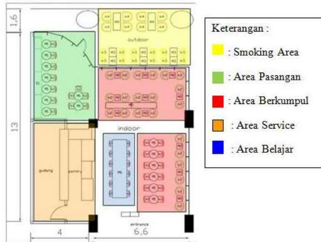
Gambar 4. Denah pembagian ruang
