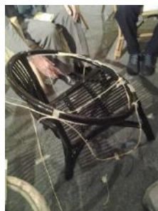
Gambar 2. Mengukur daya lengkung rotan (Dokumentasi Penulis)
