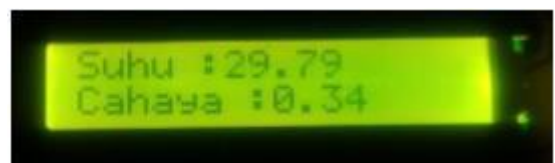
Gambar 2.5 Tampilan LCD Hasil Bacaan Sensor
