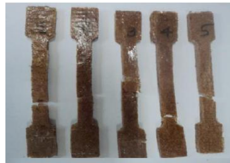
Gambar 4.2 Bentuk specimen bahan komposit PF setelah pengujian tarik
