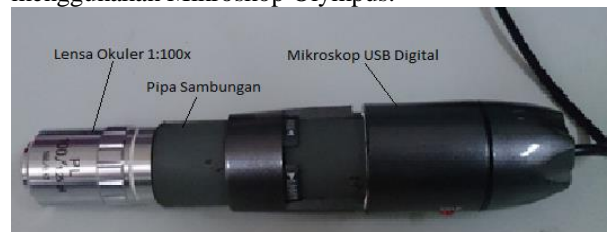
Gambar 3.7 Mikroskop USB Digital yang telah di modifikasi
