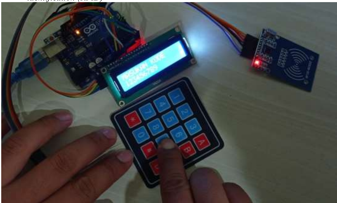
3.1.4. Pengujian : Prototype sistem keamanan pintu menggunakan Password yang benar
