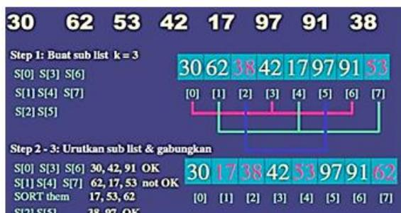
Gambar 1. Proses Perhitungan Jarak Pertama
