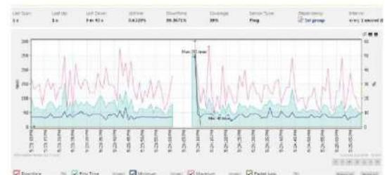
Gambar 4 Waktu maximum, minimum, dan konvergensi dengan RIPv2
