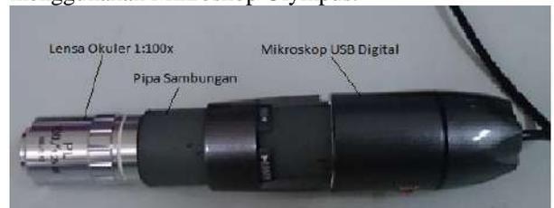
**Gambar 3.7** Mikroskop USB Digital yang telah di modifikasi
