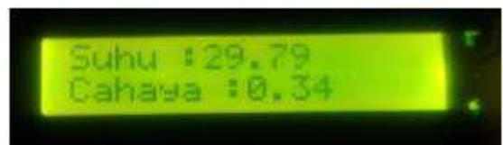
Gambar 2.5 Tampilan LCD Hasil Bacaan Sensor
