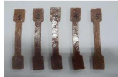
**Gambar 4.1 Bentuk specimen bahan komposit PF sebelum uji tarik**
