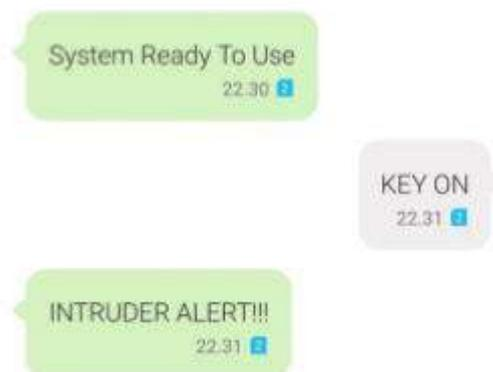
**Gambar 2.6 Pesan yang dikirimkan SIM800L**
