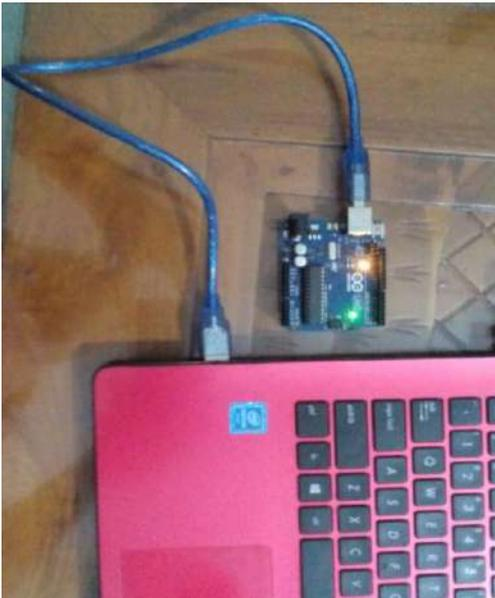
**Gambar 14. Pengisian program dari laptop ke Arduino Uno**
